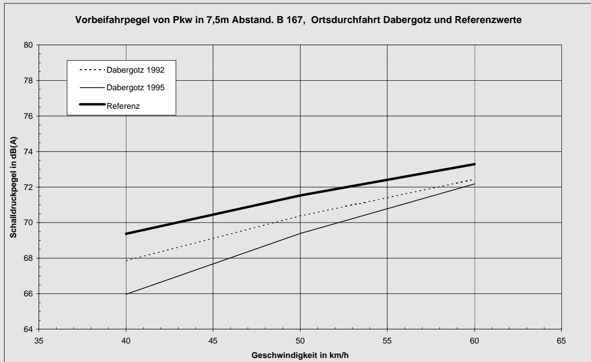
Bild 4.44: Vergleich der Vorbeifahrpegel von Pkw über der Geschwindigkeit bei den Untersuchungen in 1992 und 1995 mit Referenzwerten für eine innerörtliche Asphaltbetonstraße
